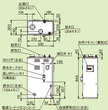
●壁面への固定は付属の「転倒防止金具大」を使用する。
