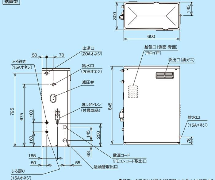
●壁面への固定は付属の「転倒防止金具大」を使用する。
