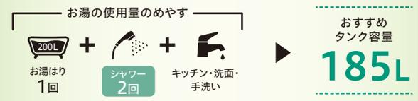
※お湯の使用量のめやす:お湯はり温度設定40℃、シャワー湯量毎分10Lで8分使用。(貯湯ユニット内温度80℃・給水温度5℃) ※使用湯量は目安であり、使い方などにより変わります。
